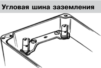
*При необходимости изоляции шины заземления от металлических проводящих частей шина должна быть установлена на изоляторы, артикул: 98704.
