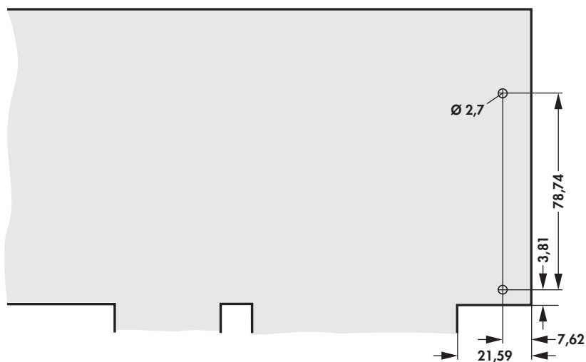
Dimensions de la fixation du support KHPC L ... sur le circuit imprimé
