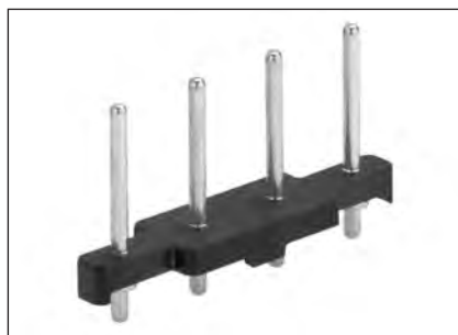
connecteur mâle à 4 pôles pour soudure THR pas de 5,75
